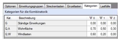
Die bei der Lasteingabe verwendeten Last-Kategorien werden aufgelistet, so dass die  $\Psi$ - Werte bei Bedarf geändert werden können.
